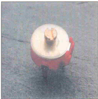
Bild 5. Der Scheiben-trimmkondensator stellt kein optimales Mittel zum CMR-Abgleich dar. Unter EMV-Aspekten muß er zudem 'richtig herum' eingesetzt werden.
